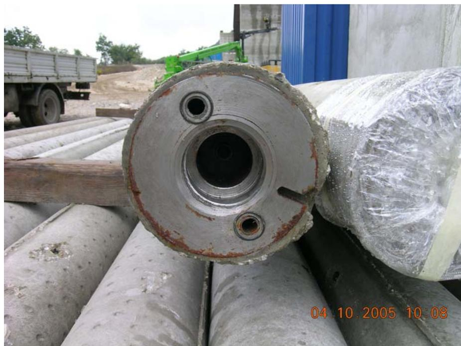
**Figura 4.9 - Particolare Dispositivo Filettato lato femmina**
