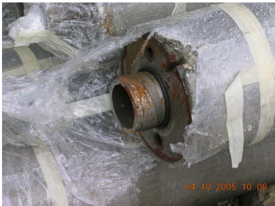
**Figura 4.8 - Particolare Dispositivo Filettato lato maschio**
