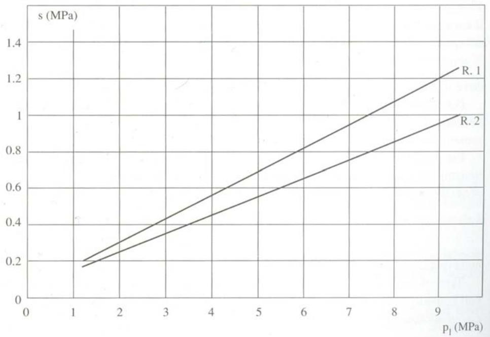
**Grafico 4.6 - Abaco per il calcolo di  $s$  per rocce alterate e fratturate**
