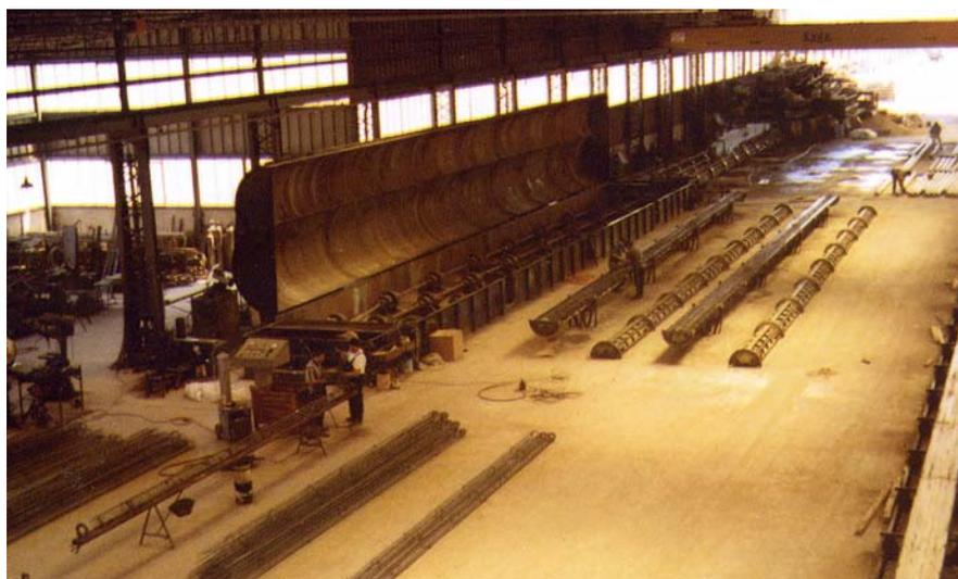
**Figura 4.7** Parte dello stabilimento Samer s.p.a. centrifuga e casseri rotanti
