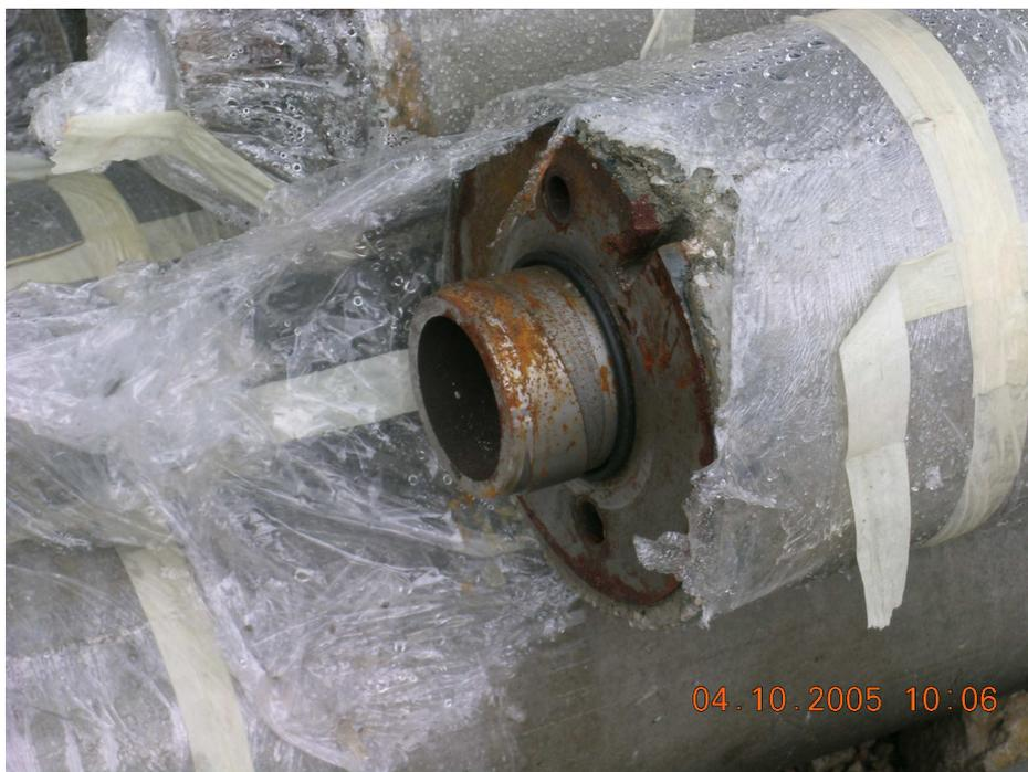
**Figura 4.10 - Particolare Dispositivo Filettato lato maschio**
