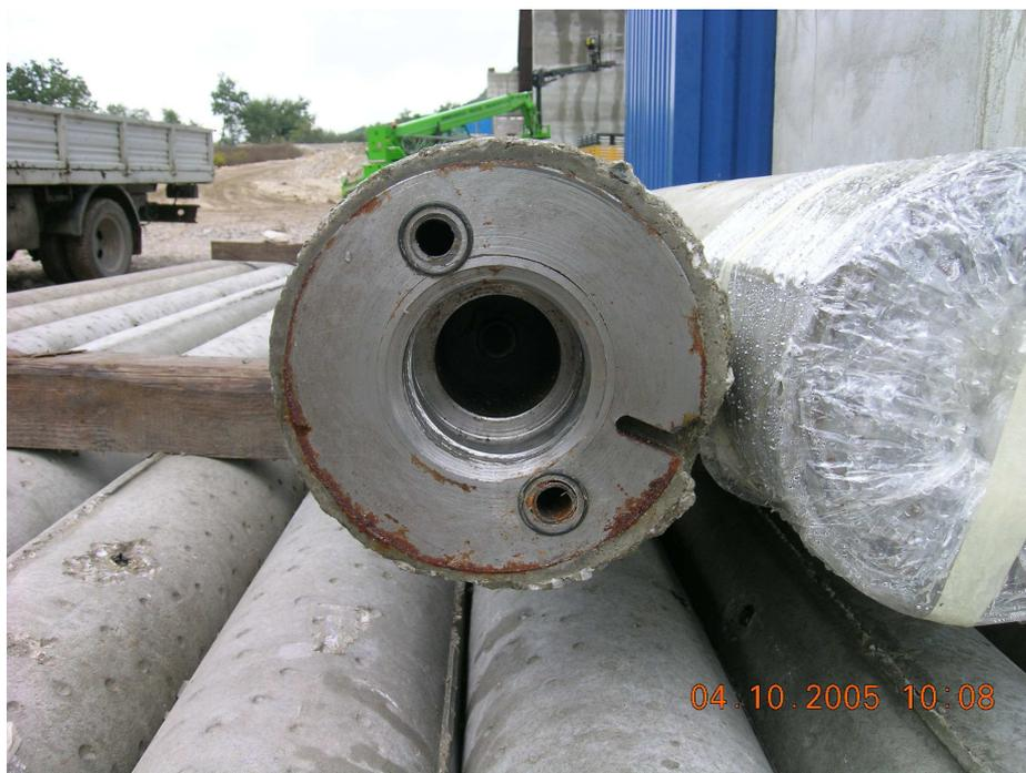
**Figura 4.11 - Particolare Dispositivo Filettato lato femmina**
