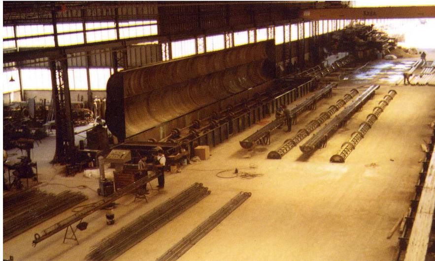
**Figura 4.8** Parte dello stabilimento Samer s.p.a. centrifuga e casseri rotanti
